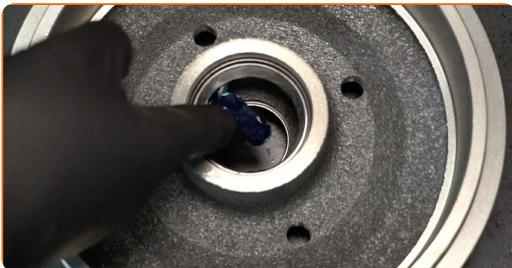
**22** Installieren Sie die Nabenlagerhalterung und sichern Sie diese.
