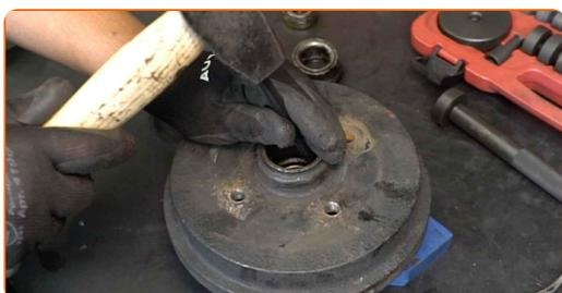
**17** Reinigen Sie den Einbauort für die Nabenlagerung. Benutzen Sie WD-40-Spray.
