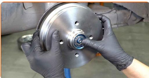
**27** Schrauben Sie die Nabenmutter an. Verwenden Sie Stecknuss Nr. 30. Verwenden Sie einen Ratschenschlüssel.
