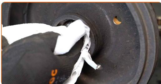
**15** Entfernen Sie den Innenring des Radlagers von der Bremstrommel. Verwenden Sie einen flachen Metallmeißel. Benutzen Sie einen Hammer.
