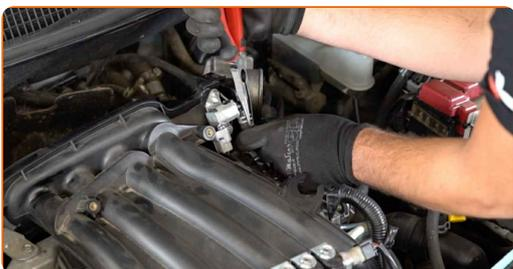
**8** Schrauben Sie die Befestigungen der Ansaugkrümmerhalterung ab. Verwenden Sie Stecknuss Nr. 10.
