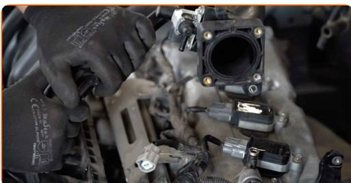
**28** Ziehen Sie die Ansaugkrümmer Befestigungen fest. Verwenden Sie Stecknuss Nr. 10. Verwenden Sie einen Drehmomentschlüssel. Ziehen Sie ihn mit 27 Nm Drehmoment fest.
