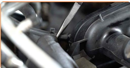
**10** Schrauben Sie die Ansaugkrümmer Befestigungen ab. Verwenden Sie Stecknuss Nr. 10. Verwenden Sie einen Ratschenschlüssel.
