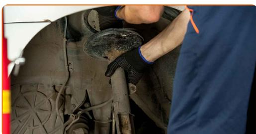
**35** Schrauben Sie die obere Befestigung des Domlagers an.
