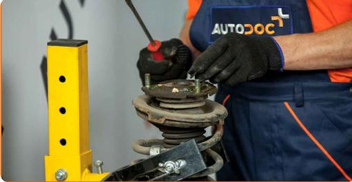
**24** Behandeln Sie die Federbeinstange. Benutzen Sie eine Drahtbürste. Benutzen Sie WD-40-Spray.
