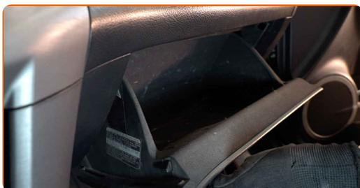
**2** Lösen Sie das Sperrkabel (Kabelband) vom Handschuhfachdeckel.
