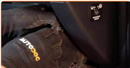
**4** Entfernen Sie den Gehäusedeckel des Innenraumfilters.
