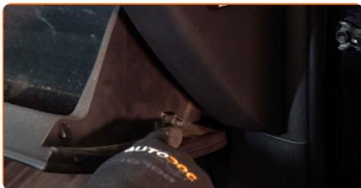
**3** Lösen Sie die Befestigungsclips der Innenraumfilterabdeckung.
