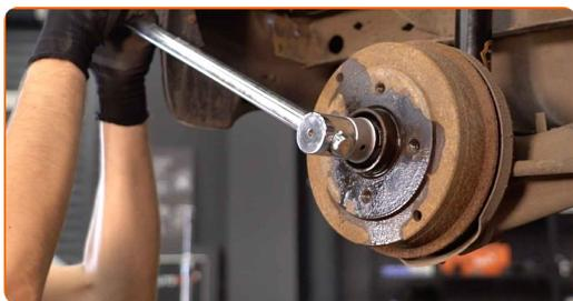
**10** Entfernen Sie die Bremstrommel.
