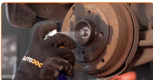
**9** Schrauben Sie die Radnaben-Achsmutter ab. Verwenden Sie Stecknuss Nr. 30. Verwenden Sie ein Windeisen.
