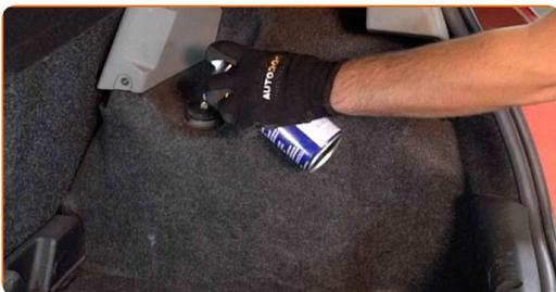
**4** Lockern Sie das obere Befestigungselement des Stoßdämpfers. Verwenden Sie Stecknuss Nr. 17. Verwenden Sie einen Stoßdämpfer Steckschlüsseleinsatz DDN#6. Verwenden Sie einen Ratschenschlüssel.
