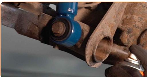
**31** Reinigen Sie die Oberfläche an welcher die Felge montiert werden soll. Benutzen Sie eine Drahtbürste. Behandeln Sie die Kontaktfläche. Benutzen Sie ein Kupferschmiermittel.
