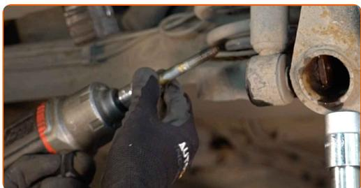
**10** Lösen Sie den unteren Teil des Stoßdämpfers.
