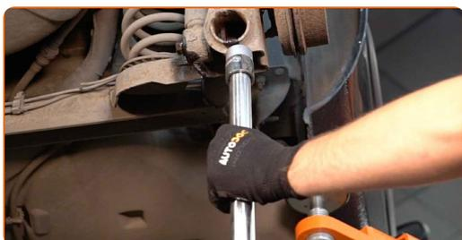
**8** Schrauben Sie den unteren Befestiger des Stoßdämpfers ab. Verwenden Sie Stecknuss Nr. 18.
