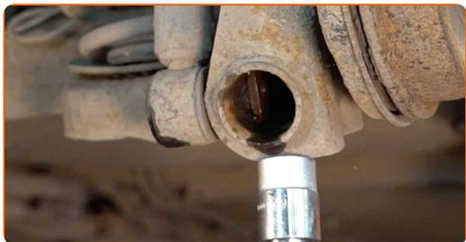
**11** Die Montage unter dem Hinterachsträger entfernen.
