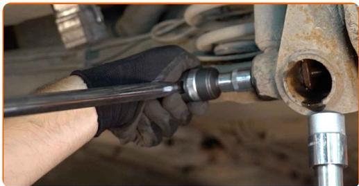
**9** Entfernen Sie die Befestigungsschraube.
