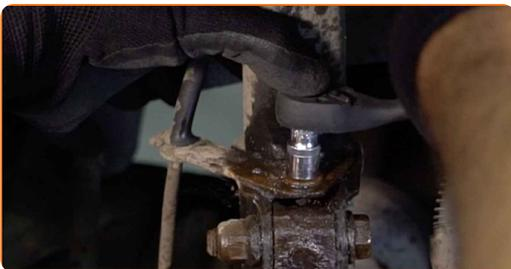
**13** Entfernen Sie die Befestigungsschrauben.
