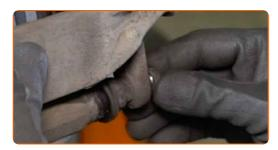
Ziehen Sie die Bremssattelbefestigungen fest. Verwenden Sie Ring-Gabelschlüssel Nr. 15. Verwenden Sie Stecknuss Nr. 13. Verwenden Sie einen Drehmomentschlüssel. Ziehen Sie ihn mit 35 Nm Drehmoment fest.
