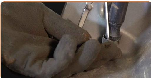
7 Lösen Sie den Sicherungsring, der die Gasfeder mit dem Kofferraumdeckel verbindet. Verwenden Sie einen flachen Schraubendreher.
