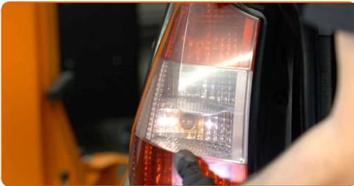
14 Schrauben Sie die Befestigungen der Heckleuchte an. Verwenden Sie einen Kreuzschlitzschraubendreher.
