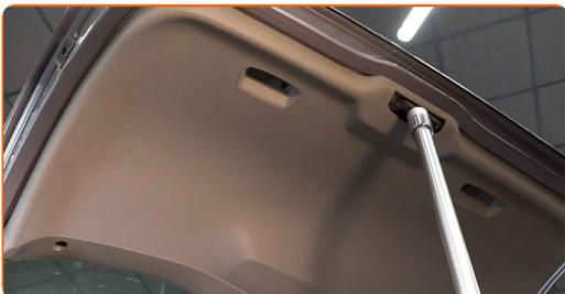
6 Lösen Sie den Sicherungsring, der die Gasfeder mit der Karosserie verbindet. Verwenden Sie einen flachen Schraubendreher.
