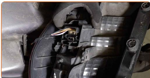
4 Trennen Sie den Glühlampen-Steckverbinder des Rücklichts. Verwenden Sie einen flachen Schraubendreher.
