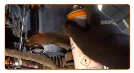
Reinigen Sie die Oberfläche an welcher die Felge montiert werden soll. Benutzen Sie eine Drahtbürste. Behandeln Sie die Kontaktfläche. Benutzen Sie ein Kupferschmiermittel.
