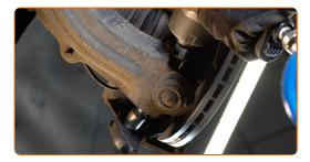
Entfernen Sie die Befestigungsschraube.
