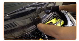
Schrauben Sie das Befestigungselement der Windlaufabdeckung ein, die sich an der linken Seite befindet. Verwenden Sie Stecknuss Nr. 10.
