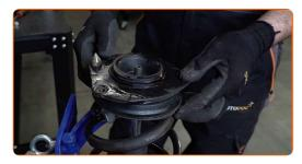
Ziehen Sie die Federbeinkolbenstangenmutter an. Verwenden Sie Ring-Gabelschlüssel Nr. 19. Verwenden Sie Inbusschlüssel Nr. H6. Verwenden Sie einen Drehmomentschlüssel. Ziehen Sie ihn mit 60 Nm Drehmoment fest.
