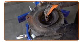
Entfernen Sie die Stangenmutter des Federkolben. Verwenden Sie Ring-Gabelschlüssel Nr. 19. Verwenden Sie Inbusschlüssel Nr. H6.
