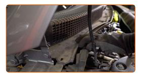
Schrauben Sie die Befestigungen der Windlaufabdeckung an, die sich auf der rechten Seite befindet. Verwenden Sie den Torx T20.
