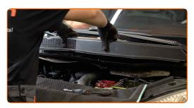
Schrauben Sie das Befestigungselement der Windlaufabdeckung heraus, die sich an der rechten Seite befindet. Verwenden Sie den Torx T20.
