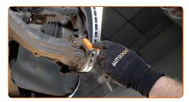
Schrauben Sie die Kugelgelenkbefestigung vom Achsschenkel ab. Verwenden Sie Stecknuss Nr. 17. Verwenden Sie einen Ratschenschlüssel.
