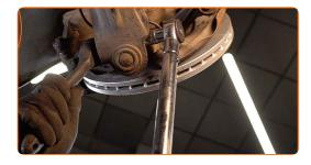
Ziehen Sie die unteren Befestigungen an, die das Federbein mit dem Achsschenkel verbinden. Verwenden Sie Stecknuss Nr. 18. Verwenden Sie einen Drehmomentschlüssel. Ziehen Sie ihn mit 105 Nm Drehmoment fest.
