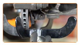
Verbinden Sie das Kugelgelenk mit dem Achsschenkel.
