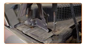
Heben Sie ein wenig die Windlaufabdeckung an, die sich an der rechten Seite befindet.
