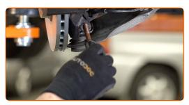
Ziehen Sie das Kugelgelenk an. Verwenden Sie Stecknuss Nr. 17. Verwenden Sie einen Ratschenschlüssel. Verwenden Sie einen Drehmomentschlüssel. Ziehen Sie ihn mit 60 Nm Drehmoment fest.
