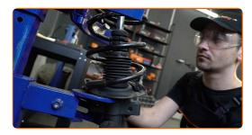
Installieren Sie das Federbein am Radlauf.
