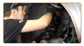
Schrauben Sie die obere Befestigung des Domlagers an. Schrauben Sie diese nicht fest.
