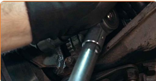
24 Schrauben Sie die Befestigungen fest, die das Kugelgelenk mit dem Querlenker verbinden. Verwenden Sie Stecknuss Nr. 18. Verwenden Sie einen Drehmomentschlüssel. Ziehen Sie ihn mit 75 Nm Drehmoment fest.
