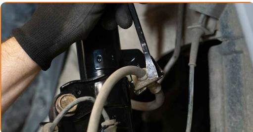
**9** Lösen Sie den Bremsschlauch vom Federbein.
