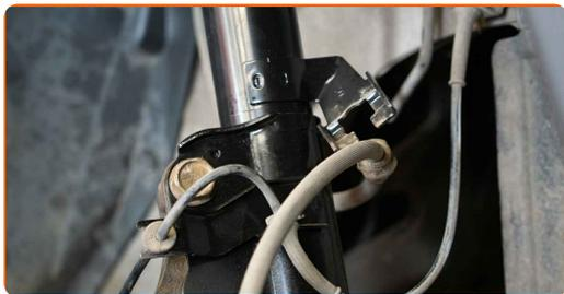
**10** Reinigen Sie den Bereich, in welchem der Bremsschlauch an den Bremssattel angeschlossen ist, sowie den Bereich der Führungsbolzen. Benutzen Sie eine Drahtbürste. Benutzen Sie einen Bremsenreiniger.
