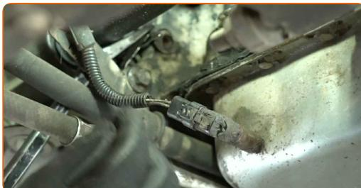
**4** Entfernen Sie die Haltefeder des Kurbelwellensensors.
