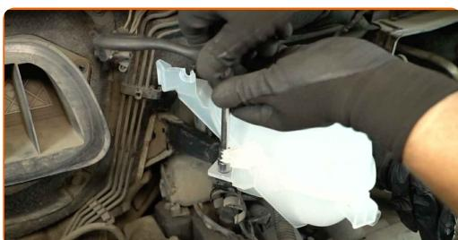
**18** Reinigen Sie die Schläuche des Ausgleichsbehälters. Verwenden Sie ein Allzweck-Reinigungsspray. Entfernen Sie die Papiertücher.
