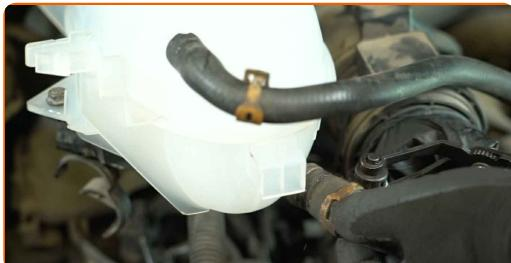
**20** Entfernen Sie den Deckel des Kühlmittelbehälters.
