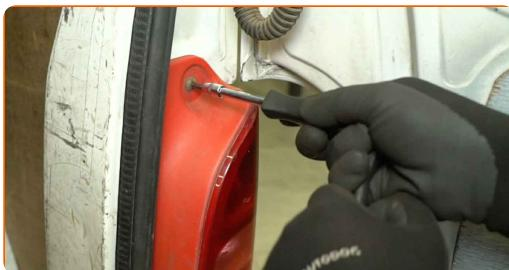
**3** Entfernen Sie die Befestigungsschraube.
