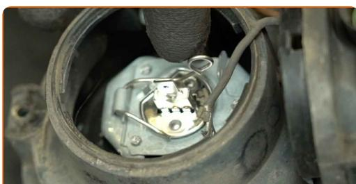
**11** Entfernen Sie die Nebelscheinwerferlampe.
