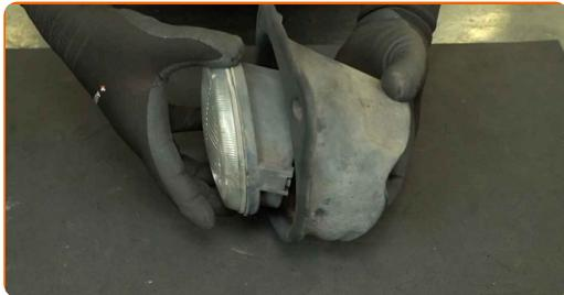
**8** Entfernen Sie die hintere Abdeckung des Nebelscheinwerfers, indem Sie sie gegen den Uhrzeigersinn drehen.
