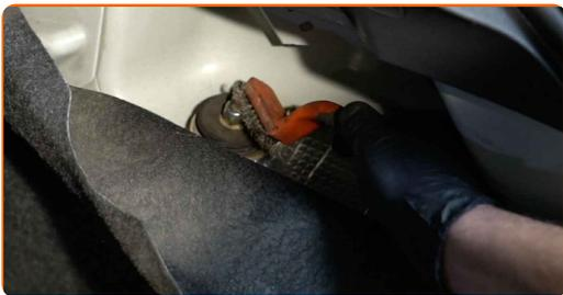
**6** Schrauben Sie das obere Befestigungselement des Stoßdämpfers ab. Verwenden Sie einen Stoßdämpfer Steckschlüsseleinsatz DDN#6 Verwenden Sie Stecknuss Nr. 16. Verwenden Sie einen Ratschenschlüssel.
