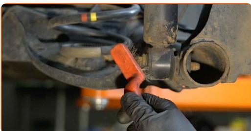
**12** Stützen Sie die Verbundlenkerachse. Benutzen Sie einen hydraulischen Getriebeheber.
