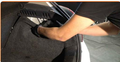
**5** Reinigen Sie die Stoßdämpferbefestigungen. Benutzen Sie eine Drahtbürste. Benutzen Sie WD-40-Spray.
