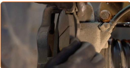
**Austausch: Bremsbeläge – RENAULT RAPID Kasten (F40\_, G40\_). Tipp:**
