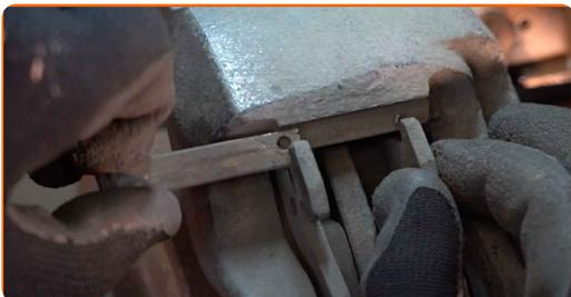
**10** Entfernen Sie die Bremsbeläge.
