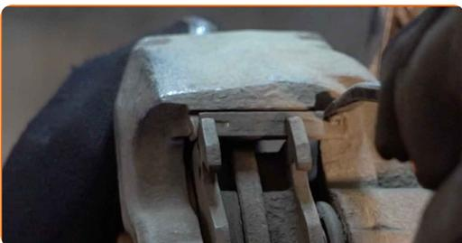
**9** Entfernen Sie die Halteklammer der Bremsbeläge.
