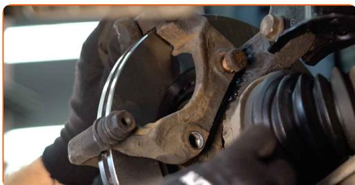
**23** Befestigen Sie die Bremssattelhalterung. Verwenden Sie Stecknuss Nr. 18. Verwenden Sie einen Drehmomentschlüssel. Ziehen Sie ihn mit 100 Nm Drehmoment fest.
