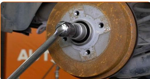
**8** Entfernen Sie die Befestigungsmutter.
