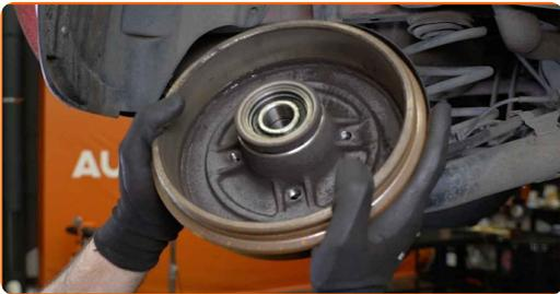
**Austausch: Radlager – RENAULT Twingo II Kasten / Schrägheck (CNO\_). Tipp:**
