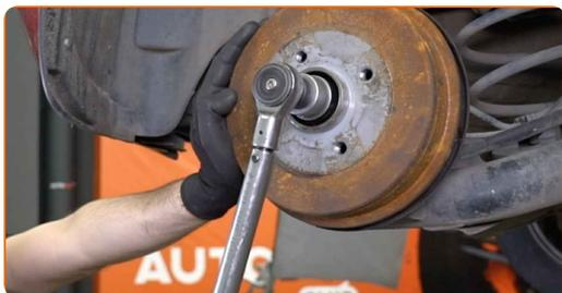
Austausch: Radlager – RENAULT Twingo II Kasten / Schrägheck (CNO\_).
