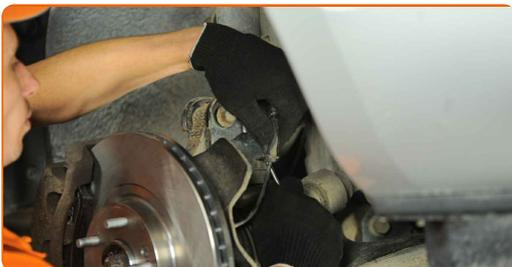
**12** Entfernen Sie die Befestigungsschrauben.
