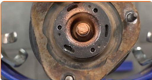
**37** Entfernen Sie das zusammengebaute Federbein.
