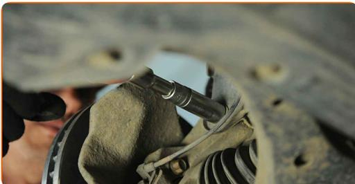
**11** Trennen Sie die Verkabelung des ABS-Sensors.
