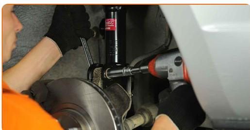
**49** Montieren Sie den Querlenker.
