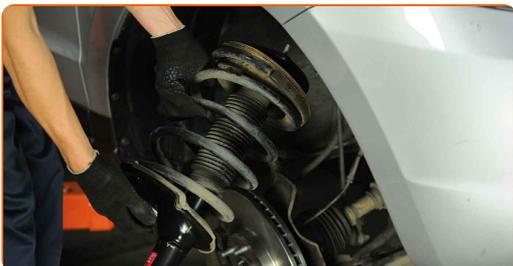
**39** Sichern Sie die oberen Befestigungen des Federbeines.
