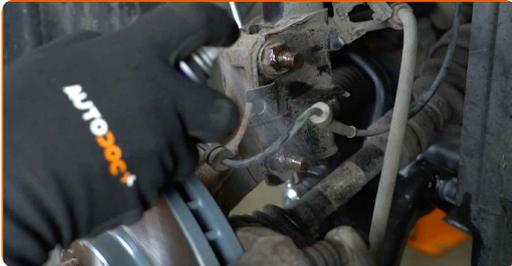
**10.1** Schrauben Sie die Befestigungen ab, die das Federbein mit dem Achsschenkel verbinden.
