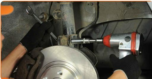
**10.2** Verwenden Sie Ring-Gabelschlüssel Nr. 19. Verwenden Sie Stecknuss Nr. 17. Verwenden Sie einen Ratschenschlüssel.
