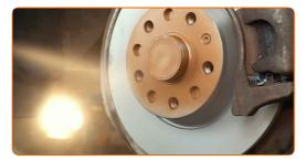
Die Bremsscheibenoberfläche reinigen. Benutzen Sie einen Bremsenreiniger.
