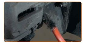
Schrauben Sie die Befestigung des Bremssattels ab. Verwenden Sie Ring-Gabelschlüssel Nr. 13. Verwenden Sie Ring-Gabelschlüssel Nr. 15. Verwenden Sie Stecknuss Nr. 13. Verwenden Sie einen Ratschenschlüssel.
