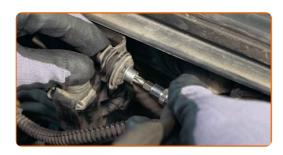
6 Schrauben Sie die Kappe des Bremsflüssigkeitsausgleichsbehälters ab.
