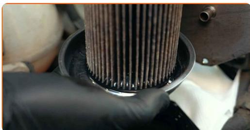
**8** Pumpen Sie den Kraftstoff aus dem Kraftstofffiltergehäuse. Verwenden Sie eine manuelle Absaugpumpe.
