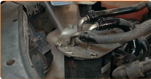
**4** Schrauben Sie die Befestigungen vom Deckel des Kraftstofffiltergehäuses ab. Verwenden Sie den Torx T15. Verwenden Sie einen Ratschenschlüssel.
