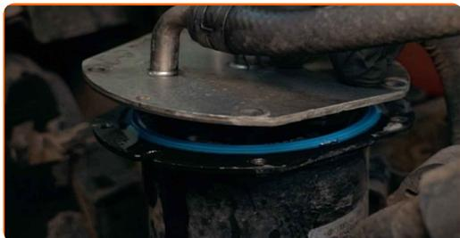
**6** Entfernen Sie den Kraftstofffilter. Verwenden Sie einen flachen Schraubendreher.
