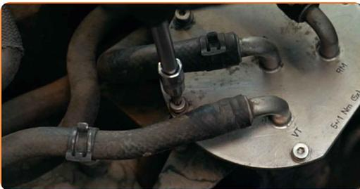
**5** Entfernen Sie den Deckel des Kraftstofffiltergehäuses. Verwenden Sie einen flachen Schraubendreher.
