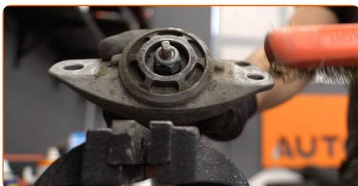
**14** Reinigen Sie die Befestigungen vom Stoßdämpferschaft. Benutzen Sie eine Drahtbürste. Benutzen Sie WD-40-Spray.
