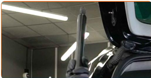
**9** Reinigen Sie den Montagesitz des Heckklappendämpfers. Benutzen Sie WD-40-Spray.
