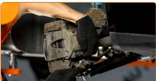
**11.1** Schrauben Sie die Befestigung des Bremssattels ab.
