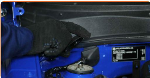
**15** Lösen Sie die obere Befestigung der Federbeinbefestigung. Verwenden Sie Ring-Gabelschlüssel Nr. 21. Verwenden Sie Inbusschlüssel Nr. H7. Verwenden Sie einen Ratschenschlüssel.
