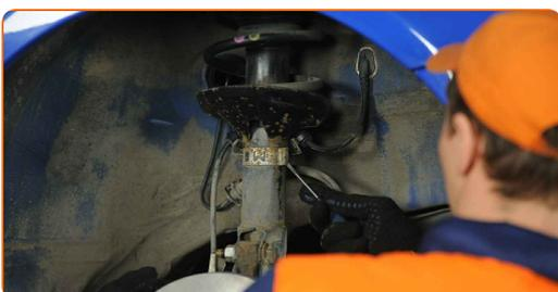
**7** Trennen Sie die ABS Sensorverdrahtung.
