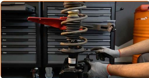
**27** Installieren Sie das Federbein am Radlauf.
