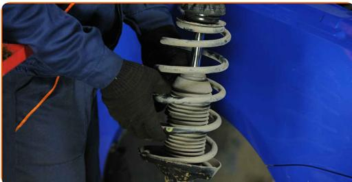
**28** Schrauben Sie die obere Befestigung des Federbeinbefestigung an.
