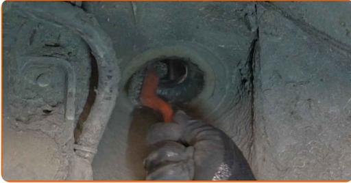
**17** Setzen Sie das neue obere Federbeinlager ein.
