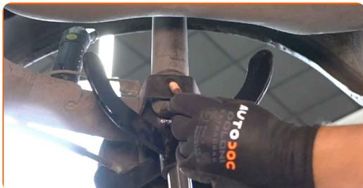
**21** Schrauben Sie das untere Befestigungselement des Federbeins ein. Verwenden Sie Ring-Gabelschlüssel Nr. 17. Verwenden Sie Stecknuss Nr. 17. Verwenden Sie ein Windeisen.
