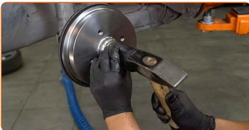
**32** Behandeln Sie die Oberfläche, an der die Radfelge die Bremstrommel berührt. Benutzen Sie ein Kupferschmiermittel.
