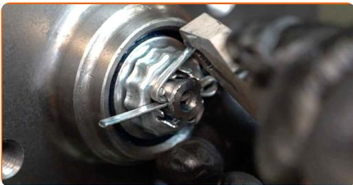
**31** Installieren Sie die Kappe der Nabenmutter. Verwenden Sie einen Gummi-Hammer.
