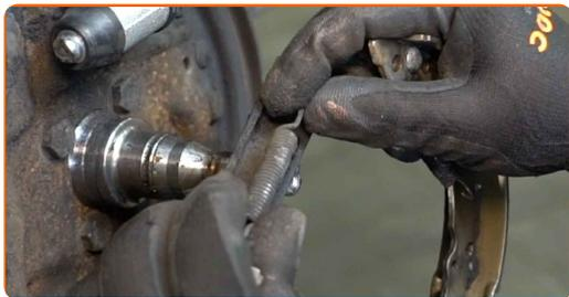
**18** Trennen Sie das Handbremskabel. Benutzen Sie ein Brecheisen.
