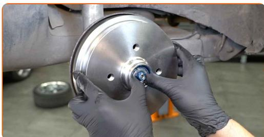
**29** Schrauben Sie die Nabenmutter an. Verwenden Sie Stecknuss Nr. 30. Verwenden Sie einen Ratschenschlüssel.
