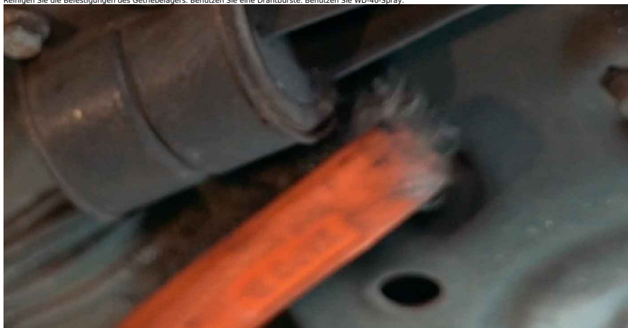
38 Schrauben Sie die Befestigungen, die das Getriebelager mit dem Hilfsrahmen verbinden, ab. Verwenden Sie Stecknuss Nr. 13. Verwenden Sie einen Ratschenschlüssel.
