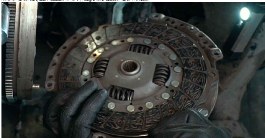
54 Reinigen Sie die Montageplätze des Kupplungssatzes. Verwenden Sie Allzweckreinigungsspray.
