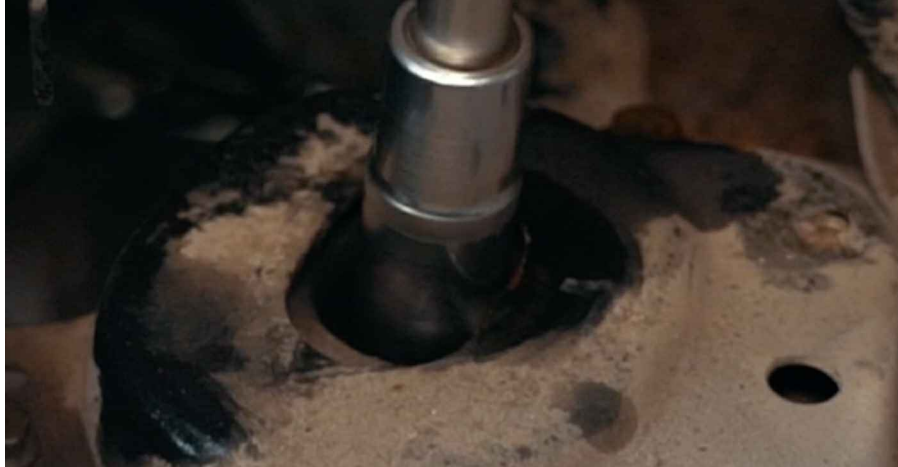
43 Schrauben Sie die Befestigungen ab, die das Getriebelager mit der Karosserie verbinden. Verwenden Sie Stecknuss Nr. 13. Verwenden Sie einen Ratschenschlüssel.
