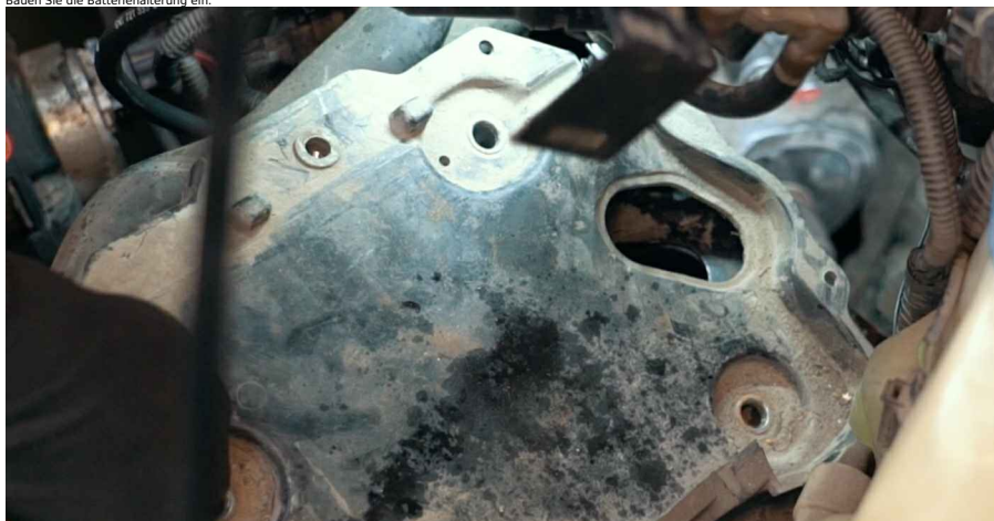
116 Schrauben Sie die Befestigungen der Batteriehalterung an. Verwenden Sie Stecknuss Nr. 10. Verwenden Sie einen Ratschenschlüssel.
