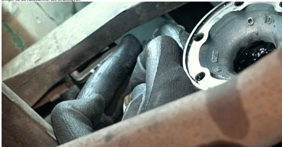
83 Schrauben Sie die Befestigung des Schaltzugs an. Verwenden Sie Stecknuss Nr. 13. Verwenden Sie einen Ratschenschlüssel. club.autodoc.de 21-32
