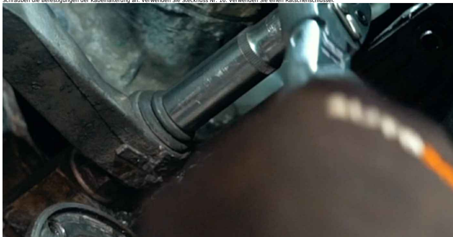
85 Ziehen die Befestigungen der Kabelhalterung an. Verwenden Sie Stecknuss Nr. 16. Verwenden Sie einen Drehmomentschlüssel. Ziehen Sie ihn mit 22 Nm Drehmoment fest.
