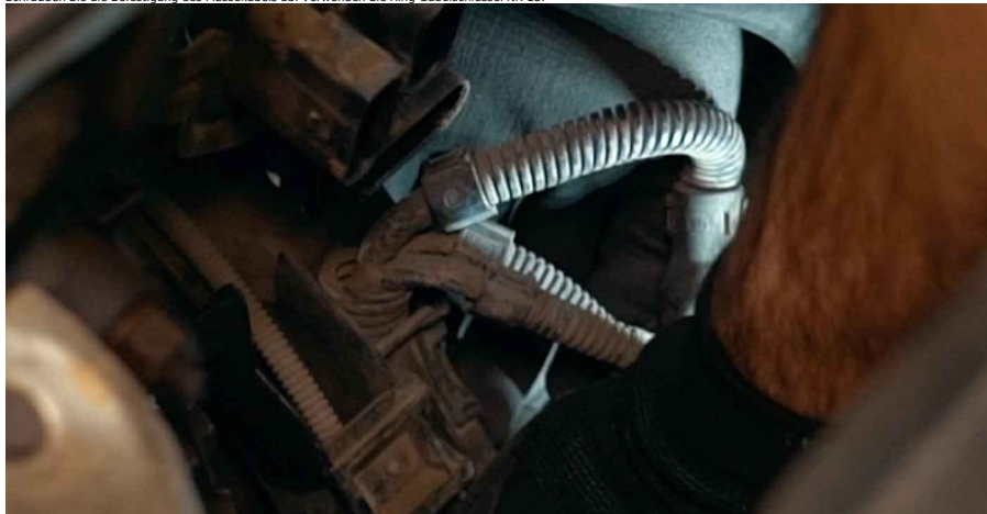
13 Trennen Sie das Massekabel.
