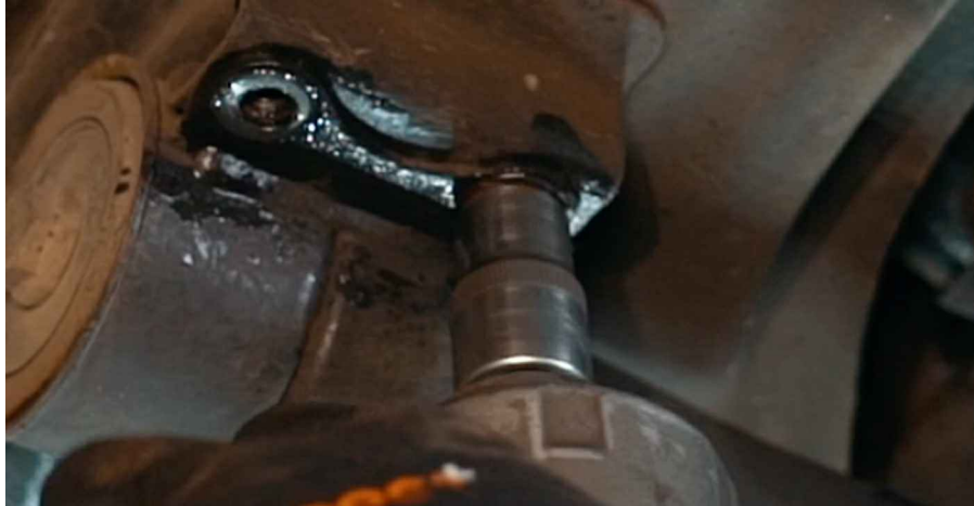
39 Entfernen Sie das Getriebelager.
