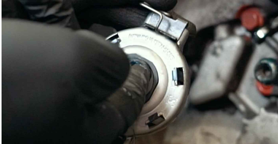
63 Bauen Sie das neue Ausrücklager ein.
