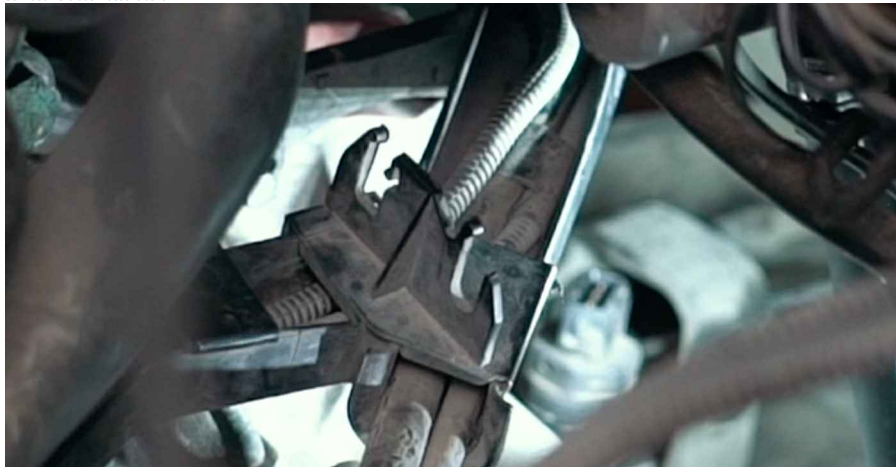
111 Schrauben Sie die Befestigung des Massekabels an. Verwenden Sie Ring-Gabelschlüssel Nr. 13.
