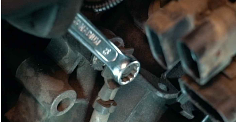
12 Schrauben Sie die Befestigung des Massekabels ab. Verwenden Sie Ring-Gabelschlüssel Nr. 13.
