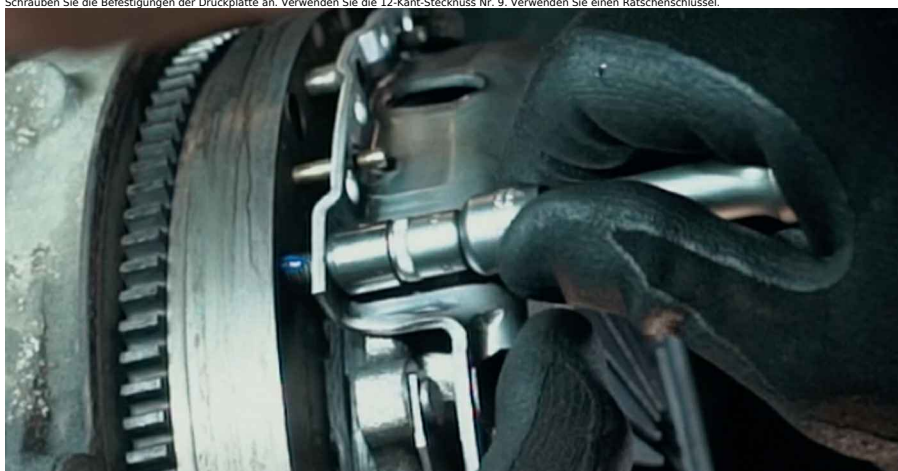
57 Passen Sie die Kupplungsscheibe an. Benutzen Sie ein Brechisen.
