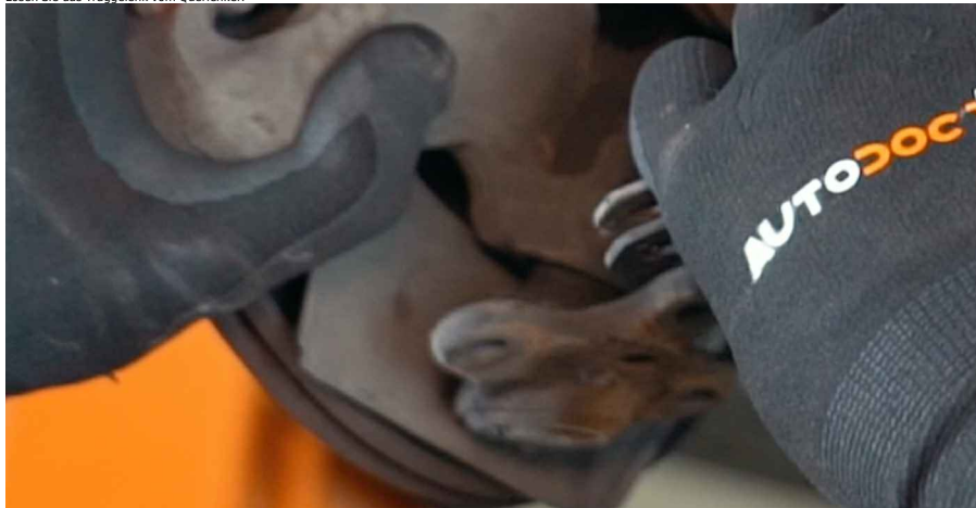
28 Trennen Sie die Antriebswelle vom Achsschenkel.
