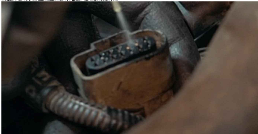
113 Verbinden Sie den Steckverbinder des Motorkabelbaums.
