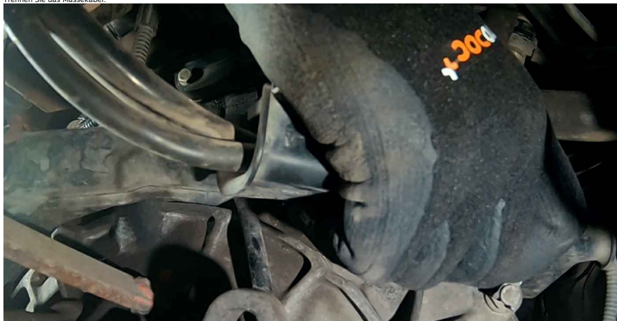
14 Schrauben Sie die Befestigungen des Motoranlassers ab. Verwenden Sie Stecknuss Nr. 13. Verwenden Sie einen Ratschenschlüssel.
