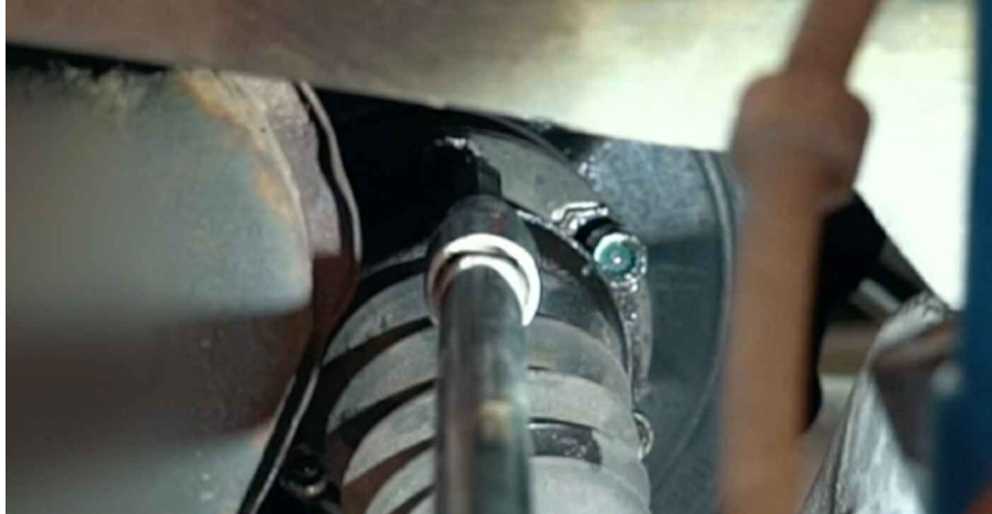
30 Entfernen Sie die Antriebswelle.
