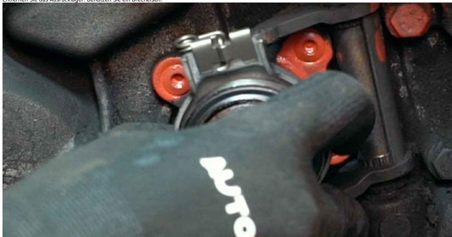
52 Schrauben Sie die Befestigungen der Druckplatte ab. Verwenden Sie die 12-Kant-Stecknuss Nr. 9. Verwenden Sie einen Ratschenschlüssel.
