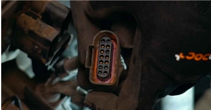
11 Lösen Sie den Motorkabelbaum.
