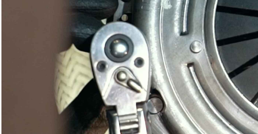
59 Installieren Sie das Arretierwerkzeug des Motorschwungrads. Verwenden Sie einen Kupplungswerkzeugsatz.
