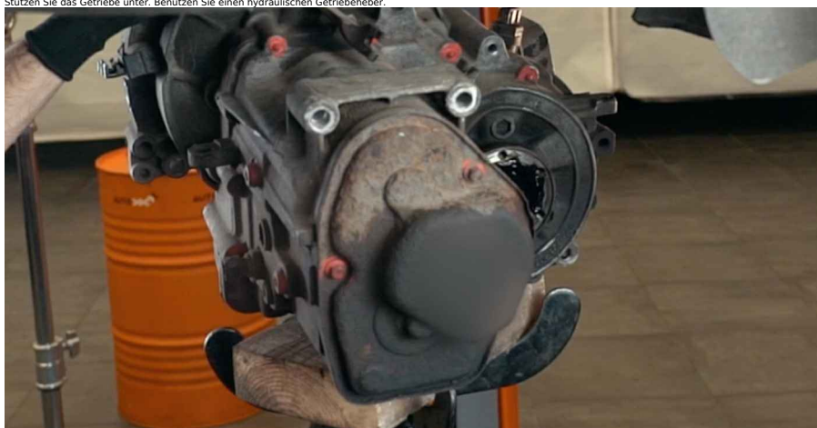
65 Installieren Sie das Getriebe.
