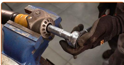
**19** Reinigen Sie die Stoßdämpferaufnahmen. Benutzen Sie eine Drahtbürste. Benutzen Sie WD-40-Spray.
