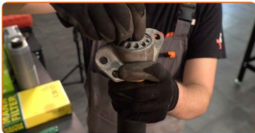
**18** Schrauben Sie die untere Befestigung der Federbeinkolbenstange an. Verwenden Sie Stecknuss Nr. 15. Verwenden Sie einen Stoßdämpfer Steckschlüsseleinsatz. Verwenden Sie einen Drehmomentschlüssel. Ziehen Sie ihn mit 25 Nm Drehmoment fest.
