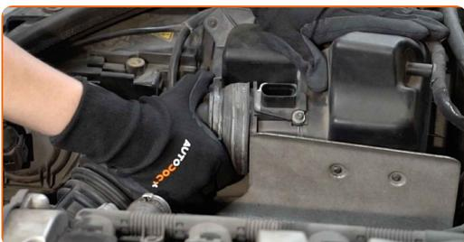
**8** Bedecken Sie den Luftansaugschlauch mit einem Mikrofaser Tuch, um zu vermeiden, dass Staub und Schmutz in das System gelangen.
