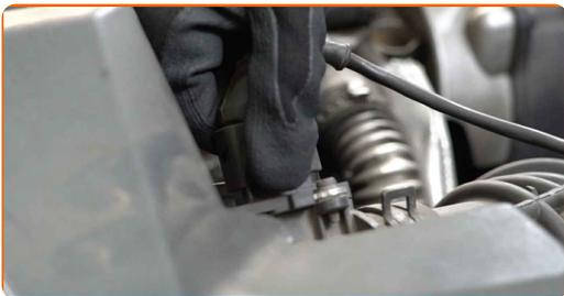
**6** Lösen Sie die Luftansaugschlauchklemme. Verwenden Sie eine Clic-R-Kragenzange.
