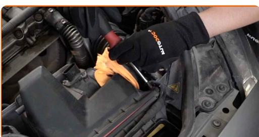
**10** Heben Sie die Abdeckung des Luftfiltergehäuses leicht an.
