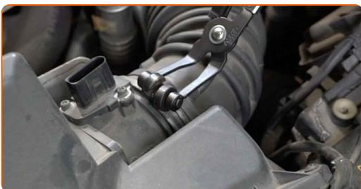
**7** Trennen Sie das Luftansaugrohr vom Luftfilter-Gehäuse.
