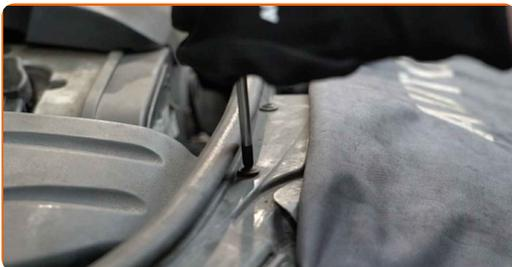
**4** Entferne die Komponenten des Lüftungskanals.
