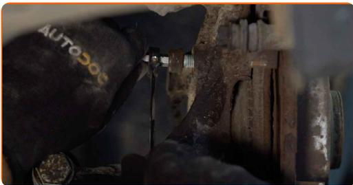
**14** Entfernen Sie die Sattelhalterung.
