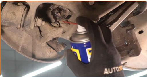
**13** Lösen Sie die Befestigung der Sattelhalterung. Verwenden Sie Inbusschlüssel Nr. H8.
