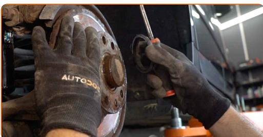
**17** Entfernen Sie die Bremsscheibe.
