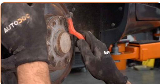
**16** Entfernen Sie den Haltering. Benutzen Sie ein Brecheisen.
