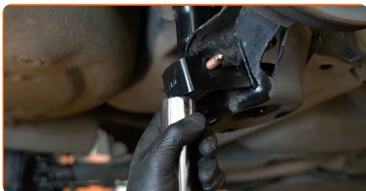
**31** Bringen Sie die Befestigungsschraube an. Verwenden Sie Ring-Gabelschlüssel Nr. 16. Verwenden Sie Stecknuss Nr. 16. Verwenden Sie einen Ratschenschlüssel.
