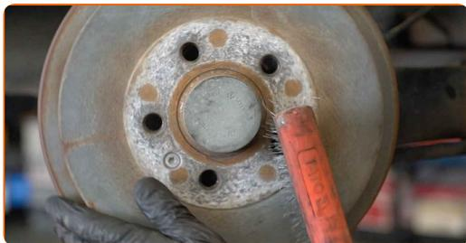
**37** Behandeln Sie die Oberfläche, an der die Radfelge die Bremstrommel berührt. Benutzen Sie ein Kupferschmiermittel.
