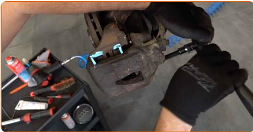
**11** Entfernen Sie den Bremssattel.
