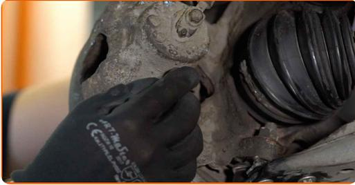
**9** Schrauben Sie die Befestigung des Bremssattels ab. Verwenden Sie Inbusschlüssel Nr. H7.
