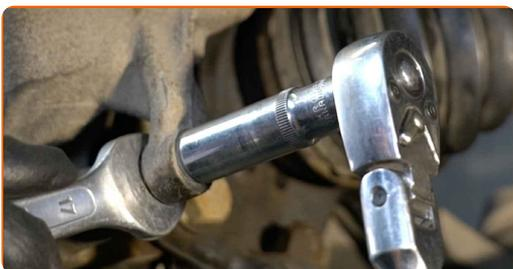
**9** Entfernen Sie die Befestigungsschrauben.
