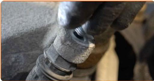
**20** Ziehen Sie die Bremssattelbefestigungen fest. Verwenden Sie Stecknuss Nr. 13. Verwenden Sie einen Drehmomentschlüssel. Ziehen Sie ihn mit 35 Nm Drehmoment fest.
