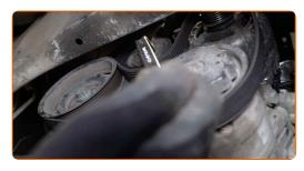
5 Entfernen Sie den Keilrippenriemen.
