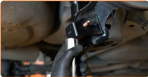
**23** Schrauben Sie das untere Befestigungselement des Stoßdämpfers ein. Verwenden Sie Ring-Gabelschlüssel Nr. 16. Verwenden Sie Stecknuss Nr. 16. Verwenden Sie einen Ratschenschlüssel.
