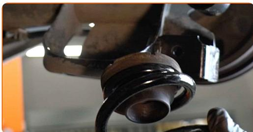
**20** Bauen Sie die Spiralfeder zusammen mit den Gummilager in deren Aufnahmen ein.
