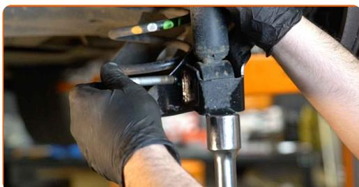
**15** Die Montage unter dem Hinterachsträger entfernen.
