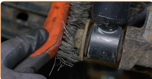
**8** Schrauben Sie den unteren Befestiger des Stoßdämpfers ab. Verwenden Sie Ring-Gabelschlüssel Nr. 21. Verwenden Sie Stecknuss Nr. 21. Verwenden Sie einen Ratschenschlüssel.
