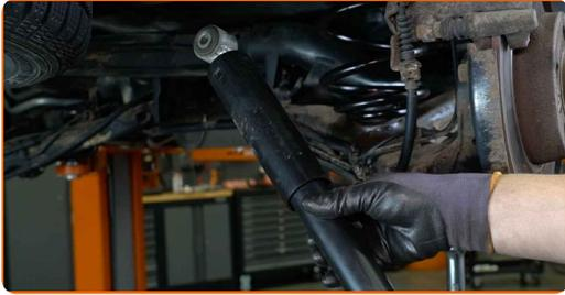
**16** Reinigen Sie die Stoßdämpferaufnahmen. Benutzen Sie eine Drahtbürste. Benutzen Sie WD-40-Spray.
