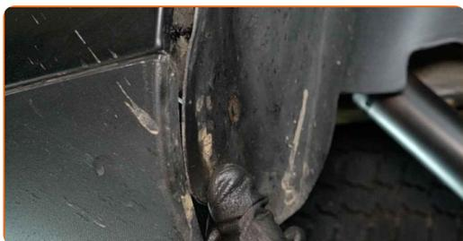
**22** Schrauben Sie die Befestigungen der Radhausschale ein. Verwenden Sie den Torx T25. Verwenden Sie einen Ratschenschlüssel.
