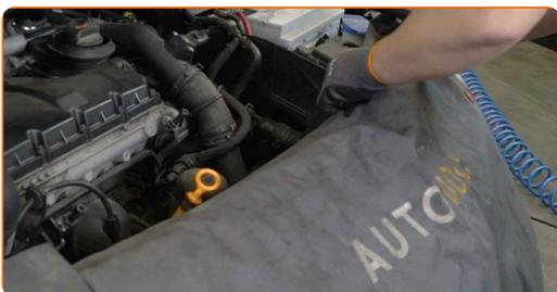
**3** Ziehen Sie die Spannrolle des Keilrippenriemens beiseite. Verwenden Sie Ring-Gabelschlüssel Nr. 16.
