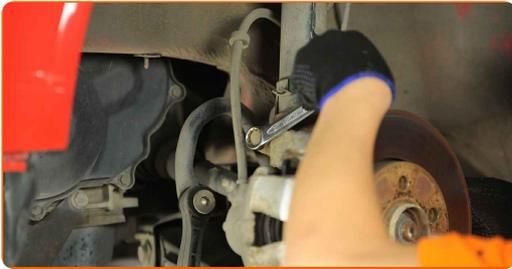
**12** Entfernen Sie die Befestigungsschraube.
