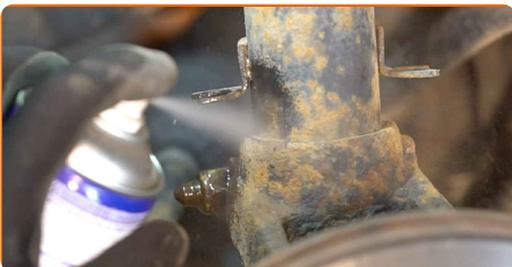
**8** Entfernen Sie die Befestigungsschraube.
