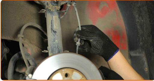
**10** Die Befestigungselemente, die das Federbein mit dem Achsschenkel verbinden, reinigen. Benutzen Sie eine Drahtbürste. Benutzen Sie WD-40-Spray.
