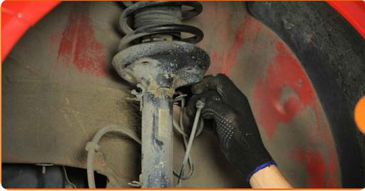
**41** Entfernen Sie den Träger unter dem Achsschenkel.
