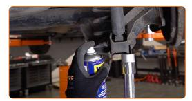
Schrauben Sie den unteren Befestiger des Stoßdämpfers ab. Verwenden Sie Ring-Gabelschlüssel Nr. 16. Verwenden Sie Stecknuss Nr. 16. Verwenden Sie einen Ratschenschlüssel.
