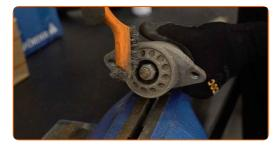
Greifen Sie den Stoßdämpfer mit einem Schraubstock.
