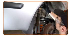
Reinigen Sie die Befestigungen vom Stoßdämpferschaft. Benutzen Sie eine Drahtbürste. Benutzen Sie WD-40-Spray.
