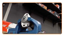
Schrauben Sie die untere Befestigung der Federbeinkolbenstange an. Verwenden Sie Ring-Gabelschlüssel Nr. 17.
