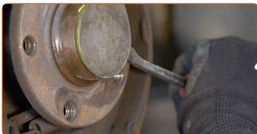
Austausch: Radlager – SKODA FABIA Stufenheck (6Y3). Tipp von AUTODOC:
