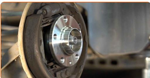
**14** Ziehen Sie die Nabe hindurch. Benutzen Sie eine 12-Kant-Nuss #30. Verwenden Sie einen Drehmomentschlüssel. Ziehen Sie ihn mit 175 Nm Drehmoment fest.
