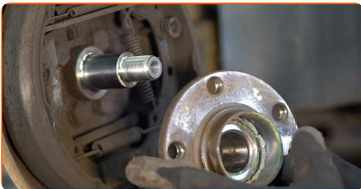
**12** Reinigen Sie den Einbauort für die Nabenlagerung. Verwenden Sie Allzweckreinigungsspray.
