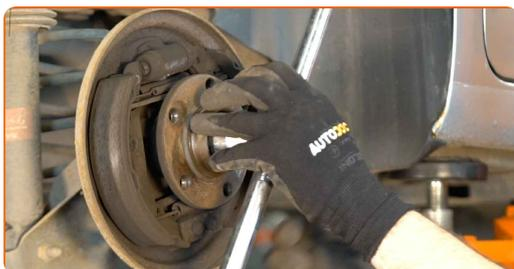
**11** Entfernen Sie die Nabe und das Lager zusammen, da sie eine versiegelte Einheit sind.
