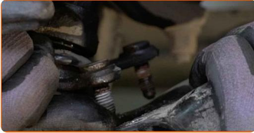
**23** Stützen Sie die Achsschenkel auf. Benutzen Sie einen hydraulischen Getriebeheber.
