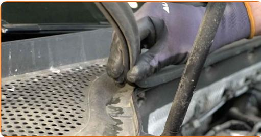
**4** Entfernen Sie die Befestigungsclips der Windlaufabdeckung. Benutzen Sie ein Brecheisen.
