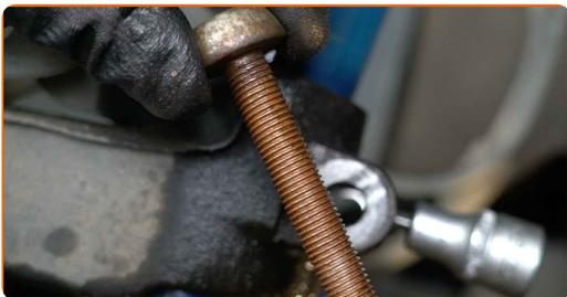
**46** Entfernen Sie den Träger unter dem Achsschenkel.
