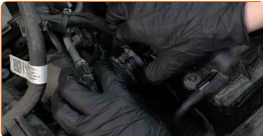
**4** Trennen Sie den Unterdruckschlauch vom Luftfiltergehäuse.
