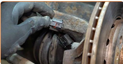
**8** Reinigen Sie die Befestigung des ABS-Sensors. Benutzen Sie eine Drahtbürste. Benutzen Sie WD-40-Spray.
