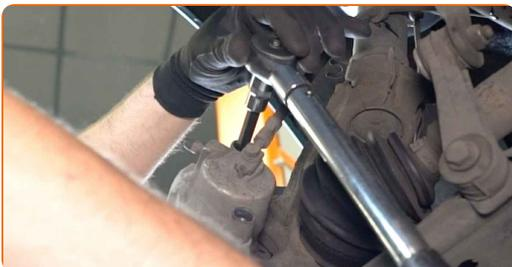
**28** Setzen Sie die Kappen auf die Führungsbolzenmanschetten des Bremssattels.
