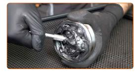
Bauen Sie das neue Gleichlaufgelenk ein. Verwenden Sie einen Druckstücksatz mit Ein-/Auspresswerkzeug. Benutzen Sie einen Hammer.
