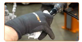
Entfernen Sie den Sicherungsring vom Gleichlaufgelenk. Verwenden Sie einen flachen Schraubendreher.
