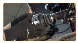
Befestigen Sie die Klemmen der Gleichlaufgelenkmanschette. Verwenden Sie einen flachen Schraubendreher. Verwenden Sie eine Clic-R-Kragenzange. Benutzen Sie einen Hammer.
