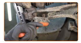
Lösen Sie das Befestigungselement, welches das Kugelgelenk am Federungsquerlenker befestigt. Verwenden Sie Stecknuss Nr. 16. Verwenden Sie einen Ratschenschlüssel.
