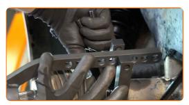
Entfernen Sie das Gleichlaufgelenk zusammen mit seiner Manschette.
