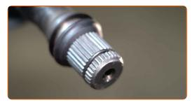
Füllen Sie das Gleichlaufgelenk mit dem im Set enthaltenen Schmierfett.
