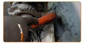
Schrauben Sie das Befestigungselement heraus, das die Druckstange mit dem Federbein verbindet. Verwenden Sie Stecknuss Nr. 19. Verwenden Sie einen Ratschenschlüssel.
