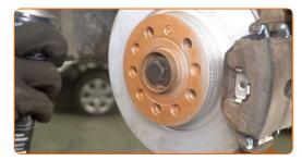
Die Bremsscheibenoberfläche reinigen. Benutzen Sie einen Bremsenreiniger.
