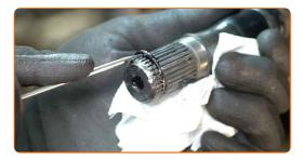
Die Keilwellen des CV-Gelenks der Antriebswelle reinigen. Benutzen Sie eine Drahtbürste. Verwenden Sie Allzweckreinigungsspray.
