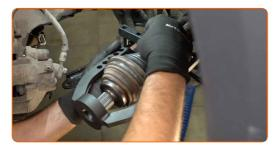
Setzen Sie den Antriebswellenschraube ein und ziehen Sie diese fest. Verwenden Sie Stecknuss Nr. 27. Verwenden Sie einen Ratschenschlüssel.
