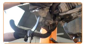
Reinigen Sie die Klemmen der Gleichlaufgelenkmanschette. Benutzen Sie eine Drahtbürste. Benutzen Sie WD-40-Spray.
