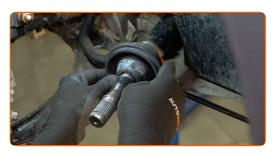
Bringen Sie den Sicherungsring am Gleichlaufgelenk an.
