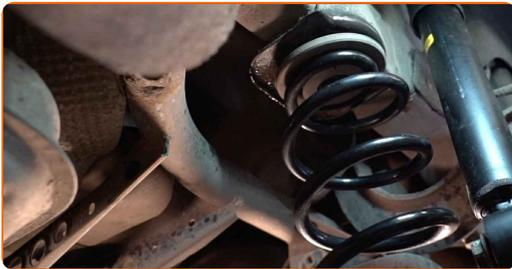
**14** Stützen Sie den Arm. Benutzen Sie einen hydraulischen Getriebeheber.
