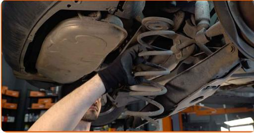
**13** Bauen Sie die Spiralfeder zusammen mit den Gummilager in deren Aufnahmen ein. Benutzen Sie ein Brecheisen.
